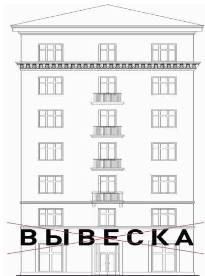
Рисунок 12. Нарушение требований к местам размещения вывесок (пункт 3.17.2.17.1 Правил).
